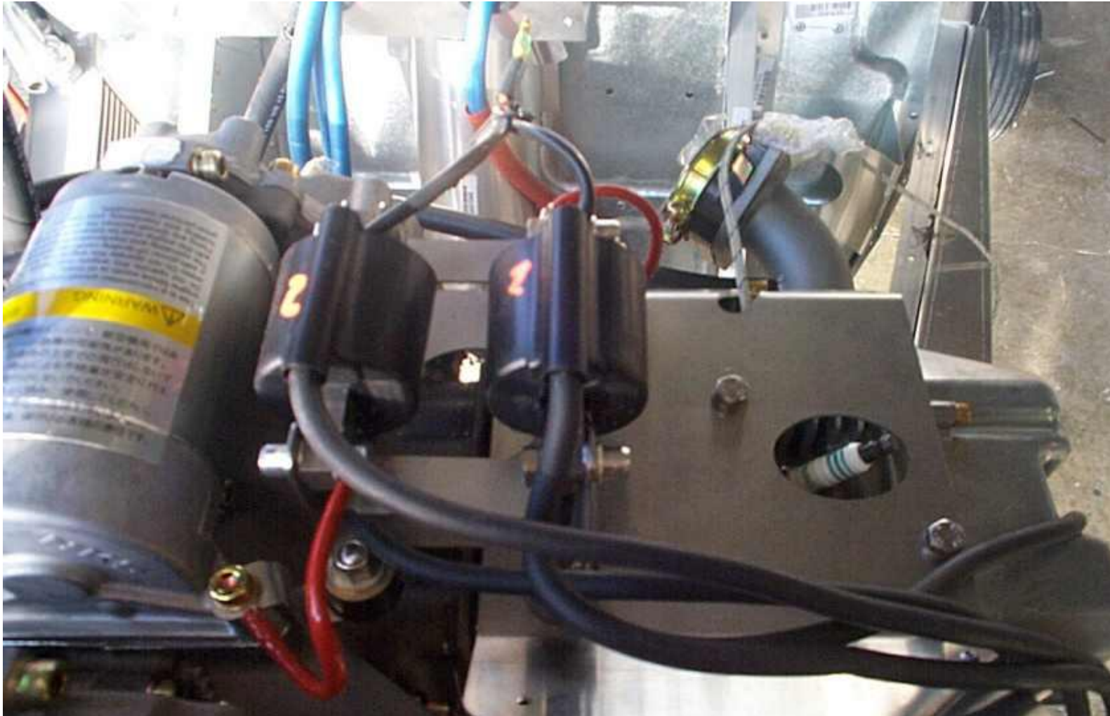
Installazione del supporto bobine in corrispondenza della testata sinistra, con in evidenza il doppio cavetto di massa / Installation of support of coils on left head, note the double ground cable / Installation du support bobines en regard de la culasse gauche, avec le double câble de masse mis en évidence / Instalación del soporte bobinas a nivel de la cabeza izquierda, destacando el doble cable de masa.
