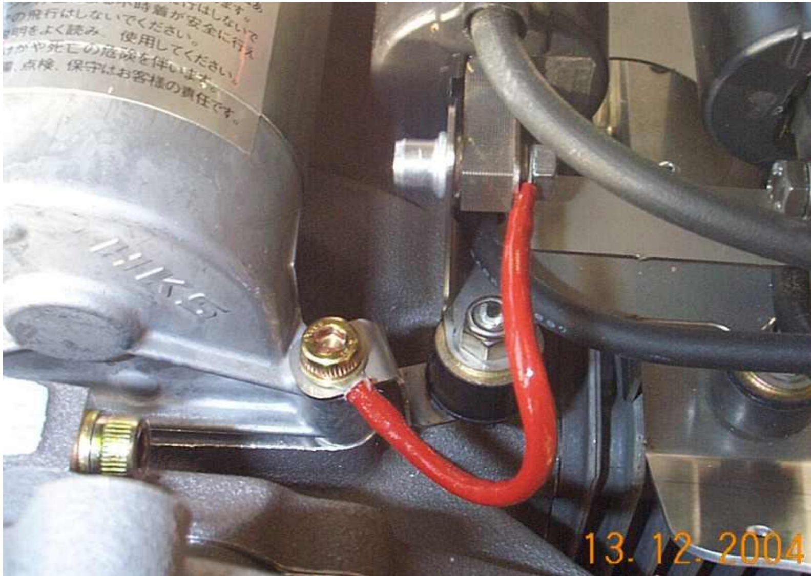
Dettaglio di installazione del cavetto di massa sul motorino di avviamento / Installation detail of ground cable on engine starter motor / Détail de l'installation du câble de masse sur le démarreur / Detalle de la instalación del cable de masa en el estárter.
